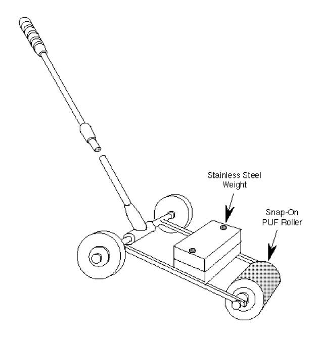
Figure B6-1. PUF Roller Sampling Instrument
