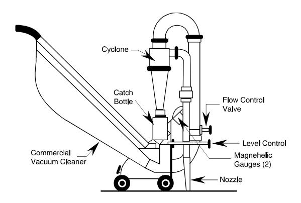
Figure B6-4. HVS3 Sampling Device
