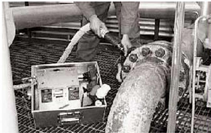
图3 使用大容量采样器测量泄漏 (来源：Oil&Gas Journal, May 21, 2001)
