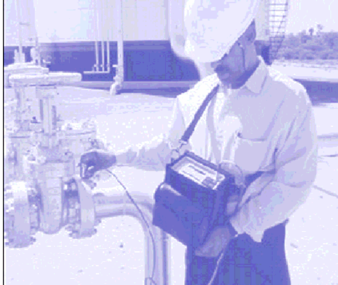
图2 声波泄漏探测器 (来源: Physical Acoustics Corp.)
