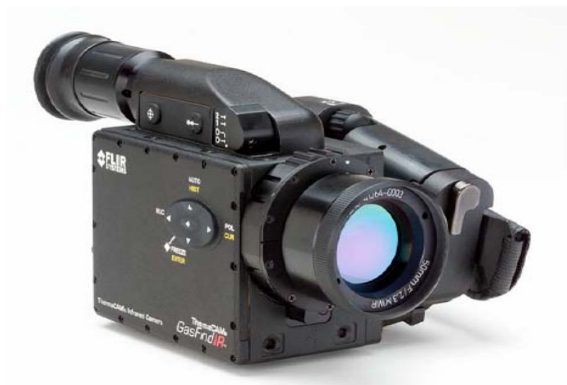
图 A-1 用于可视化逃逸性设备泄漏的手持式光学成像摄像机
