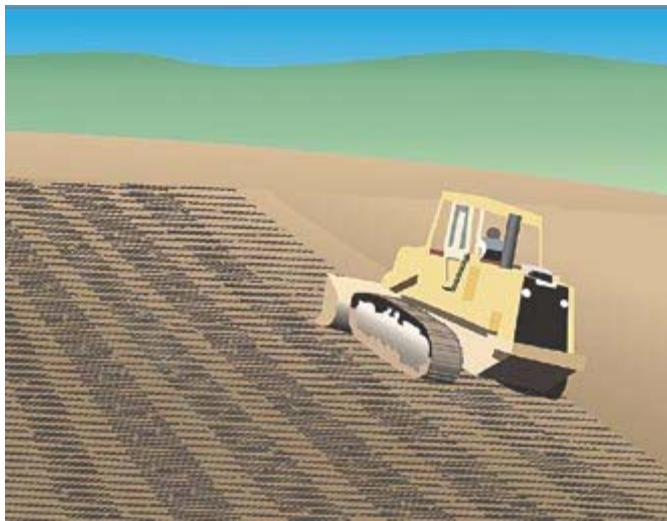
Apisonar la tierra dejando líneas (oruga) arriba y abajo de la colina para mejorar la estabilidad.
