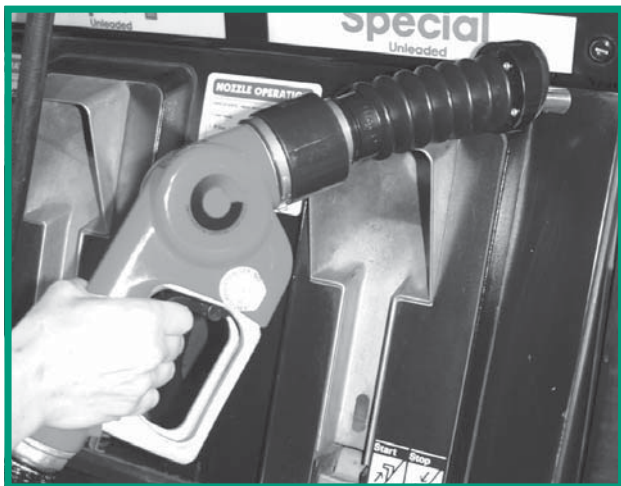
《清洁空气法案》要求在某些地区的加油站安装蒸汽回收喷嘴。这些气泵喷嘴可减少人们在给汽车加油时被释放到空气中的汽油蒸汽。
