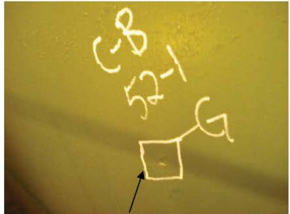
B-P52-1 GOUGE REPAIR
