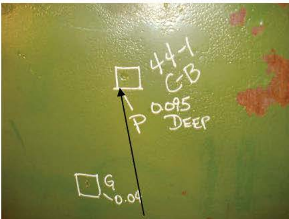
B-P44-1 GOUGE REPAIR
