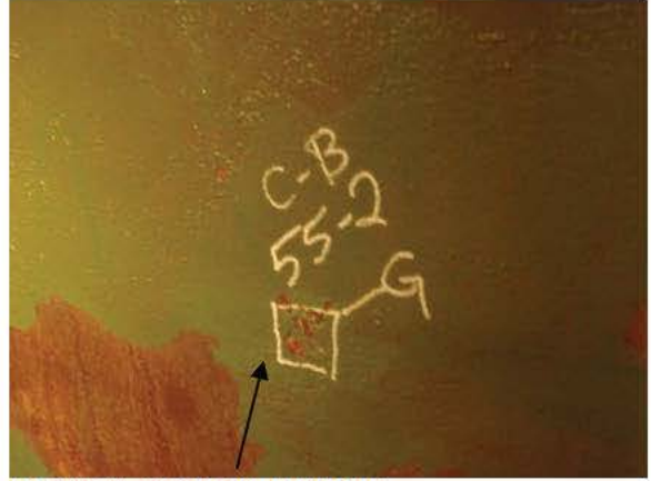
B-P55-2 GOUGE REPAIR
