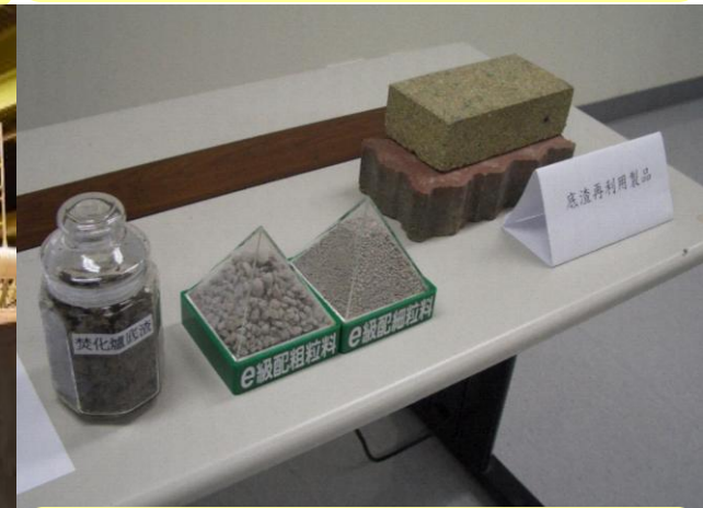
6. 底渣再利用 Bottom Ash Recycling
