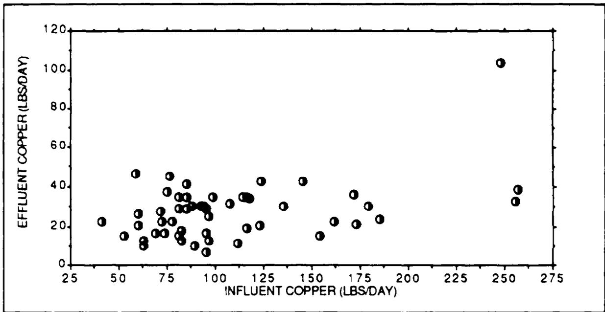
FIGURE 4. INFLUENT COPPER vs. EFFLUENT COPPER
