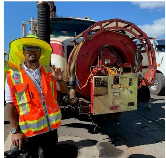
*Figura 1.: El líder del Grupo de Trabajo de Aguas Residuales de la EPA explica cómo el camión de CCTV ayuda a evaluar la condición de las líneas de alcantarillado.*
