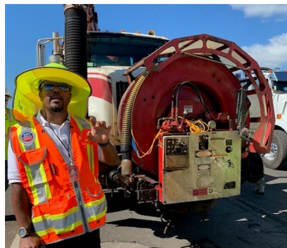
Figure 1.: Ipinapaliwanag ng EPA Wastewater Task Force Leader kung paano tumutulong ang CCTV truck na matasa ang kondisyon ng mga sewer line.
