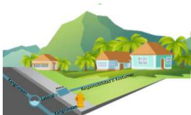
Ladawan 1. Grapiko a mangipakpakita ti koneksion ti kangrunaan a linya ti danum iti hydrant ken
