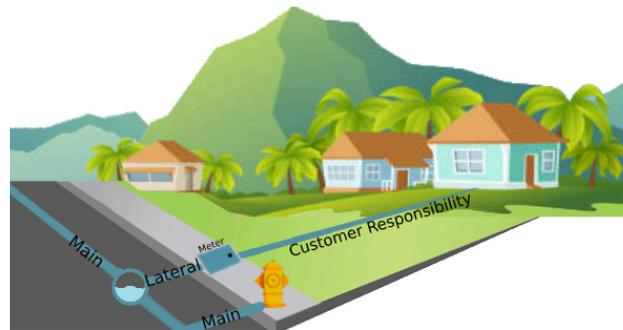
Figura 1. Ilustración que muestra la conexión a la tubería principal de agua de la boca de agua y la tubería lateral residencial.
