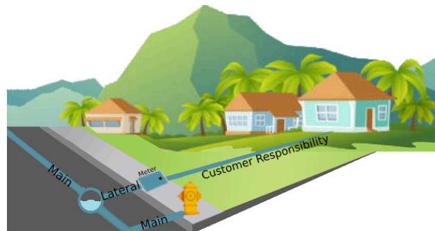
Figure 1. Ang larawan ay nagpapakita ng main water line na nakakonekta sa hydrant at residential lateral line.
