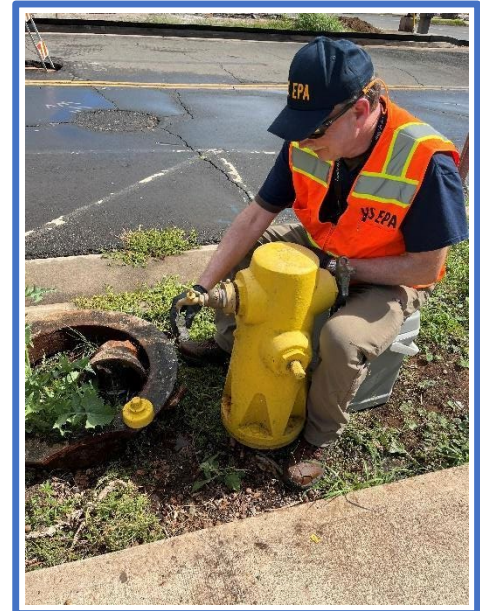
Ladawan 1. Miembro ti tripulante ti EPA a mangalala iti sample manipud iti sistema iti panagiwara iti fire hydrant.
