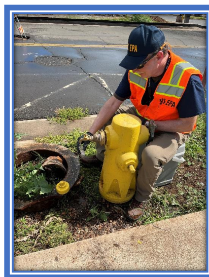
Figura 1. Miembro del equipo de la EPA que toma una muestra del sistema de distribución en una boca de incendios.
