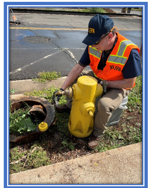
Larawan 1. Ang crew member ng EPA ay kumukuha ng sample para sa distribution system galing sa isang fire hydrant.
