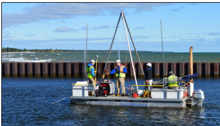
Figura 3. Un ejemplo de muestreo de sedimentos en un recipiente vibracore. Fuente: https://www.affiliatedresearchers.com/vibracore-sediment-sampling-projects/
