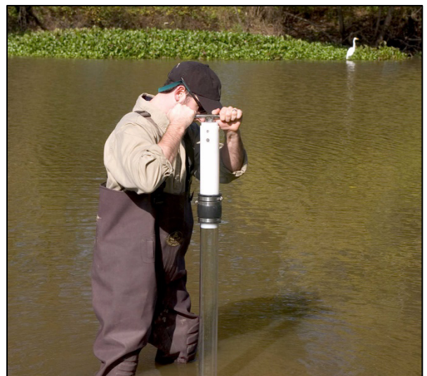
Figura 4. Un ejemplo de muestreo de sedimentos utilizando un muestreador de núcleos. Fuente: http://www.forestry-suppliers.com/product_pages/products.php?mi=70121
